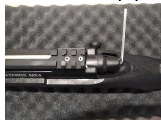
Ota ením klí e ve sm ru hodinových ru i ek se více p edepíná pru0ina ventilu a tím se zkracuje doba a délka chodu otev ení ventilu, ím0 se sní0uje spot ebu vzduchu a p i jezd vyzzmí uta0ení i výkon puzky. Zárove p íliz velké p edepnutí pru0iny ventilu zhorzuje konzistenci ús ové rychlosit.
